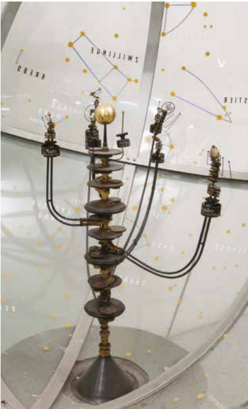
Im inneren des gläsernen Himmelsglobus von 1906 werden Planeten und deren Monde über Zahnräder angetrieben. Zu sehen in der Ausstellung »Zeitmessung« im Deutschen Museum.
